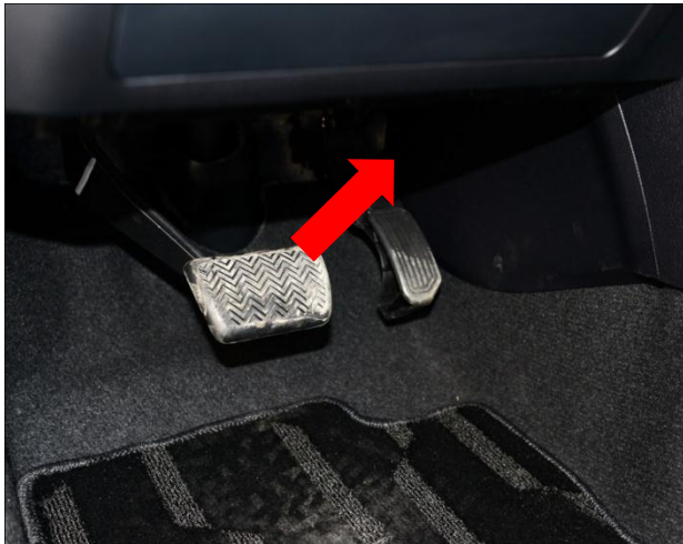
右踏板电机布线：把电机线通过脚下海绵，穿过副驾驶位。(右边电机线较长)
