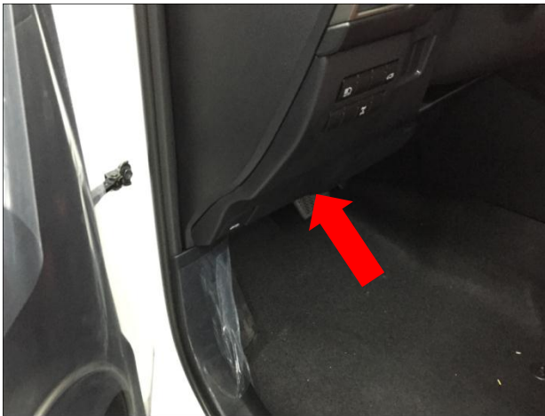
右踏板电机布线：把电机线通过脚下海绵，穿过副驾驶位。(右边电机线较长)
