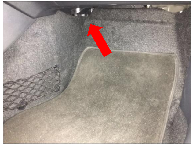
右踏板电机布线：通过副驾驶位把线隐藏在海绵下，延伸至迎宾踏板处(虚线)
