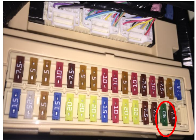
接正极线：在内部看到原车保险盒，圆圈位置原车 30A 保险丝为正极；(mini 保险丝或按照旧款接法)
